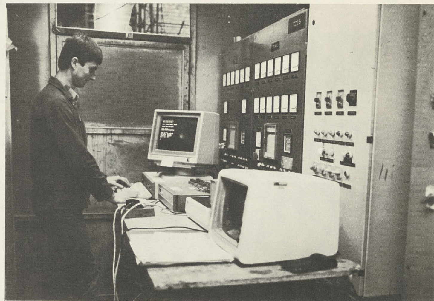
Tudi v hrastniško proizvodnjo si vse bolj utirata pot elektronika in računalništvo. Na sliki: sistem računalniškega vodenja talilne peči v Steklarni-Sijaj.
