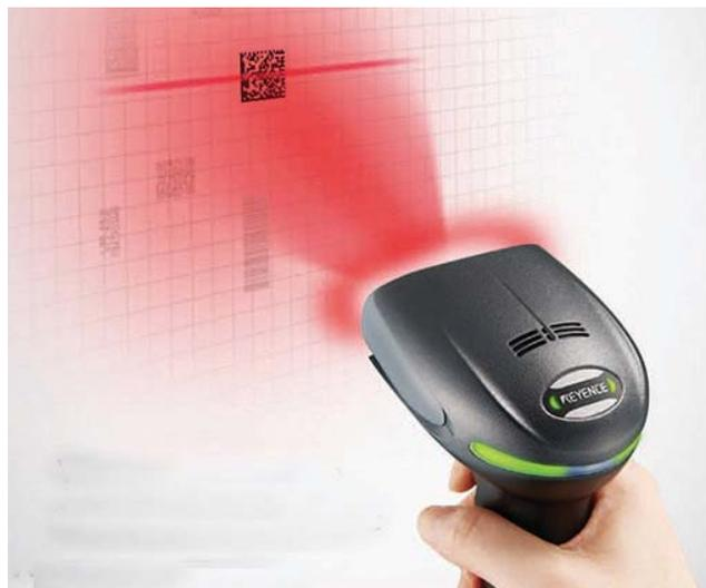
lahko z individualnimi nastavitvami izhodnih funkcij kode nastavite branje tiskane kode. Še en inovativni vidik naprave HR-100 je visoka resolucija z najmanjšo resolucijo 0,127 mm, kar omogoča branje tankih kod in povečuje uporabnost čitalnika za različne namene.
