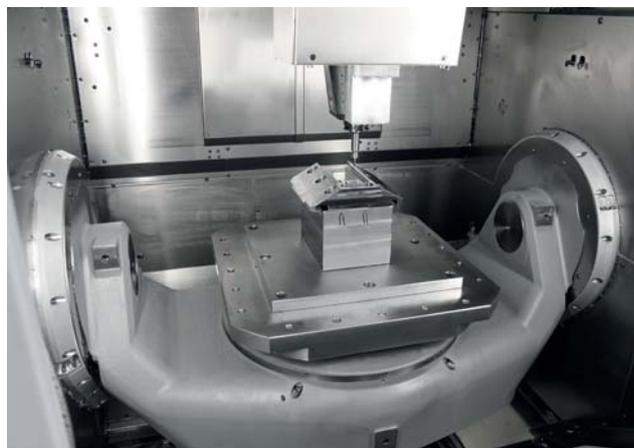
» *Velik delovni prostor petosnega visokozmogljivega CNC-obdelovalnega centra C 42 U z NC-nagibno/vrtljivo mizo in izmenljivo paleto (630 x 630 mm) s posebnim sistemom za vpenjanje obdelovanca*
