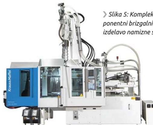
► Slika 5: Kompleksni trikomponentni brizgalni sistem za izdelavo namizne svetilke
