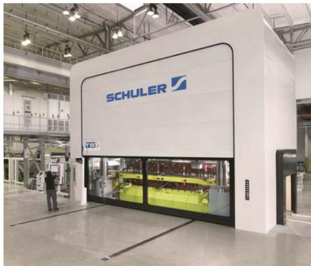
skupine Schuler. Poskusna linija, sestavljena iz nove stiskalnice z dvema servomotorjema, razvijalca, ravnalca in podajalca pločevine ter triosne naprave za transfer izdelkov, zagotavlja ekonomično, fleksibilno, predvsem pa zanesljivo proizvodno linijo.
