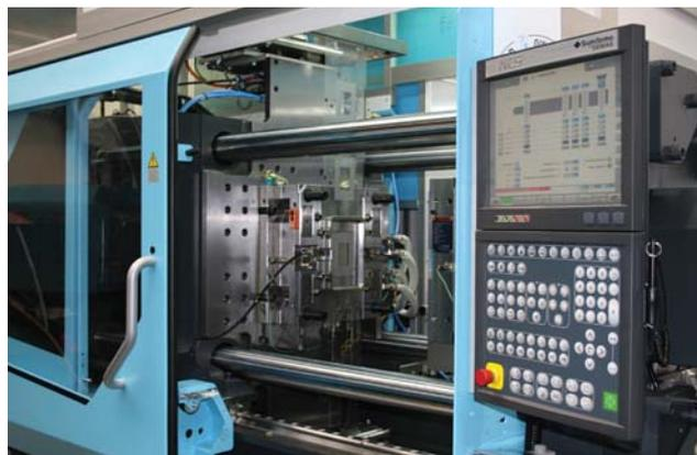
► Slika 11: Večnamenski stroj Systec 210 kot vrhunec na Fakumi 2012: Kompaktna proizvodna enota združuje funkcije za IML- in IMD-folijo za površinsko dekoracijo, ki proizvaja 3,5-palčni zaslon kot nadzorno ploščo.
