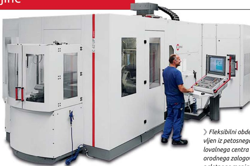
» *Fleksibilni obdelovalni sistem Hermle, sestavljen iz petosnega visokozmogljivega CNC-obdelovalnega centra C 42 U (zadaj levo), dodatnega orodnega zalogovnika ZM 43 (zadaj desno) in paletnega menjalca PW 850*
