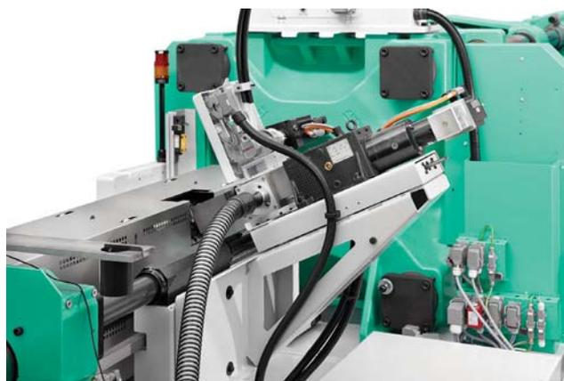
› Slika 7: Stroj in modul za dovajanje »dolгих vlaken«
