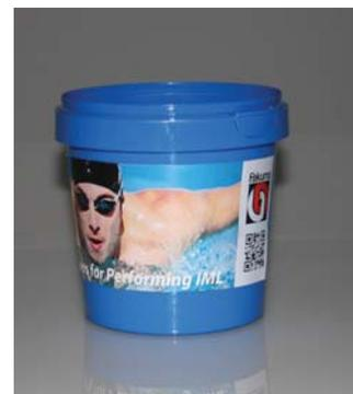
► Slika 12: Vedra s prostornino en liter iz PP so izdelana z dvojnimi orodjem na hibridnem stroju El-Exis SP 250, visokozmogljivem stroju (2500 kN), v okviru časovnega cikla manj kot 4,5 s, in nato okrašena z IML ter odstranjena prek stranskega vhoda proizvajalca SEPRO Robotique.
