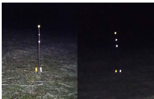
Slika 28: Primerjava odseva različnih vrst odsevnikov. Postavitev odsevnikov je enaka kot na Sliki 2, le da sta na tleh še mačji očesi (oranžno in belo). Na levi sliki so odsevniki bližje viru svetlobe kot na desni sliki.
