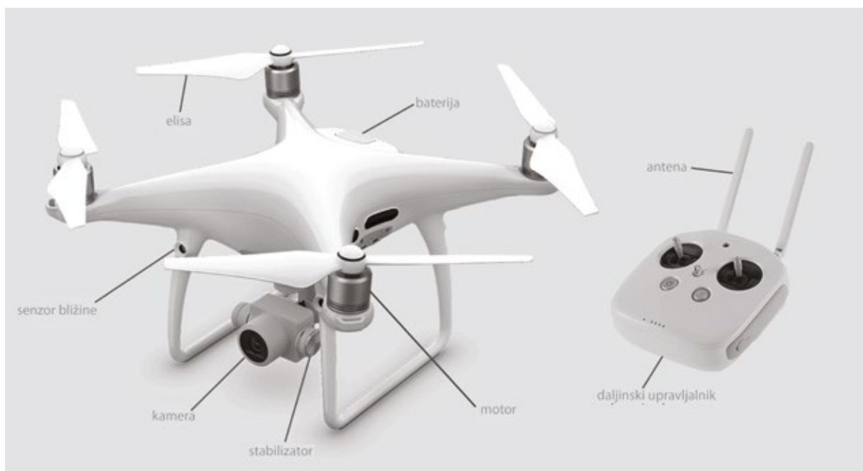
Slika 1: Sestavni deli brezpilotnega zrakoplova (Avtor: Zaletelj 2020).
