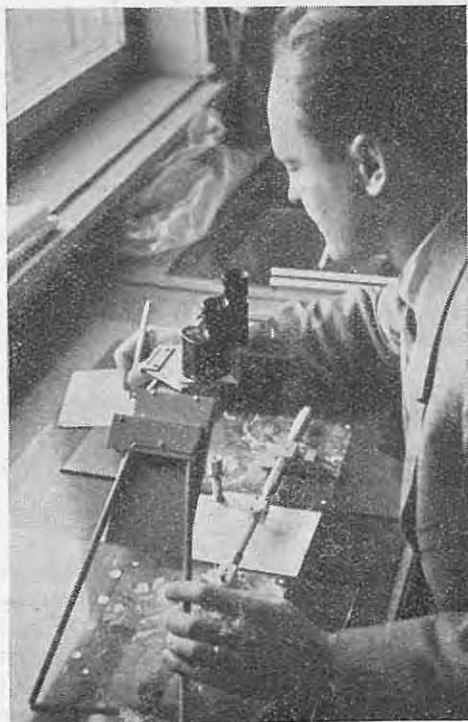
Levo: Delo s Zeissovim zrcalnim stereoskopom in stereometrom. Desno: Detajl fotogrametričnega instrumenta tipe Wild A-7. (Foto: V. Mikuletič.)
