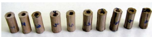
Slika 1: Uravnovešeni vzorci lesa bukve in hrasta doba za merjenje FID signala.
