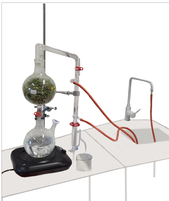
Slika 3 Laboratorijska parna destilacija iz ene rastline laškega smilja
