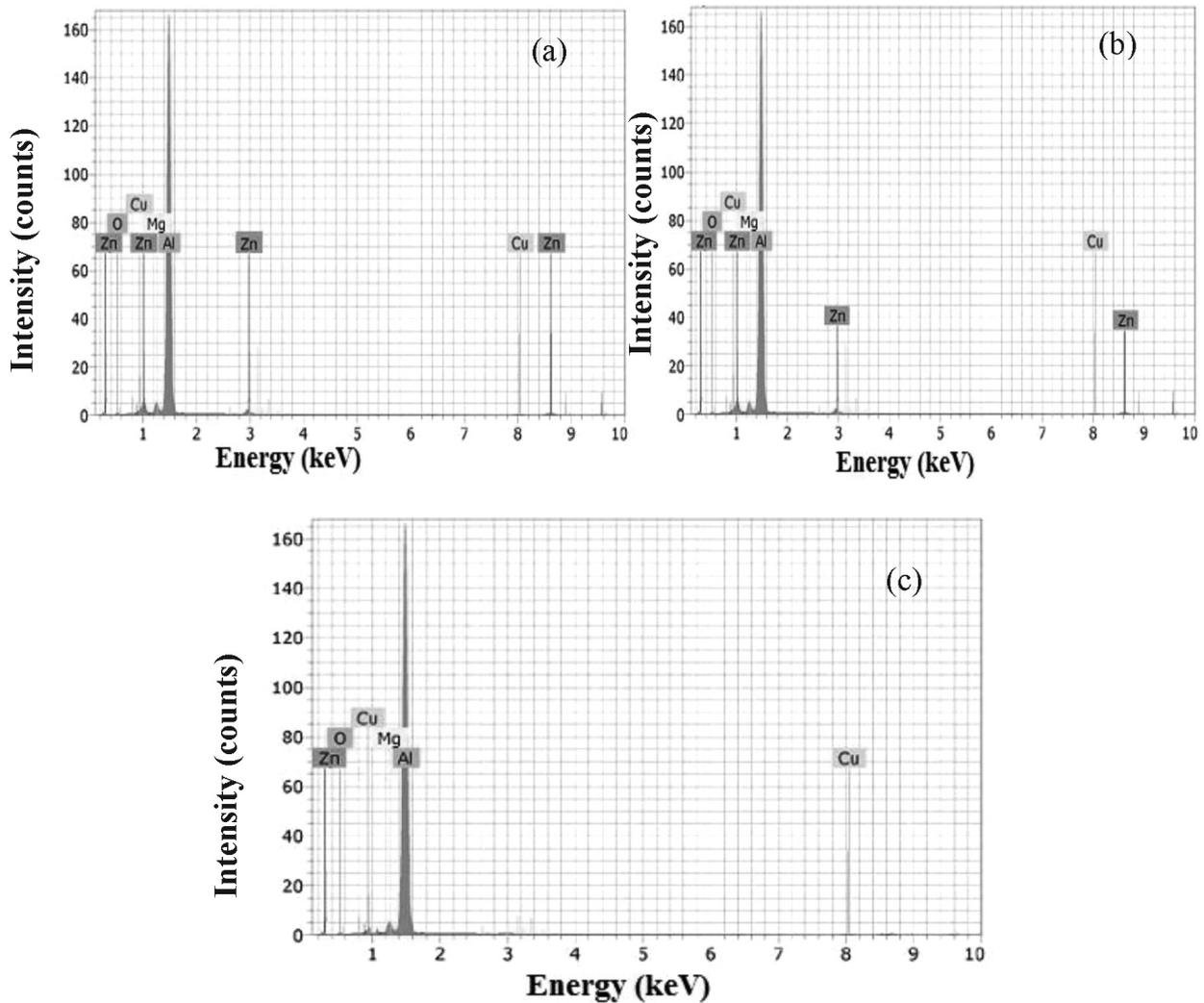
Figure 8: EDX analysis after prior annealing at: a) 300 °C, b) 400 °C, c) 500 °C
