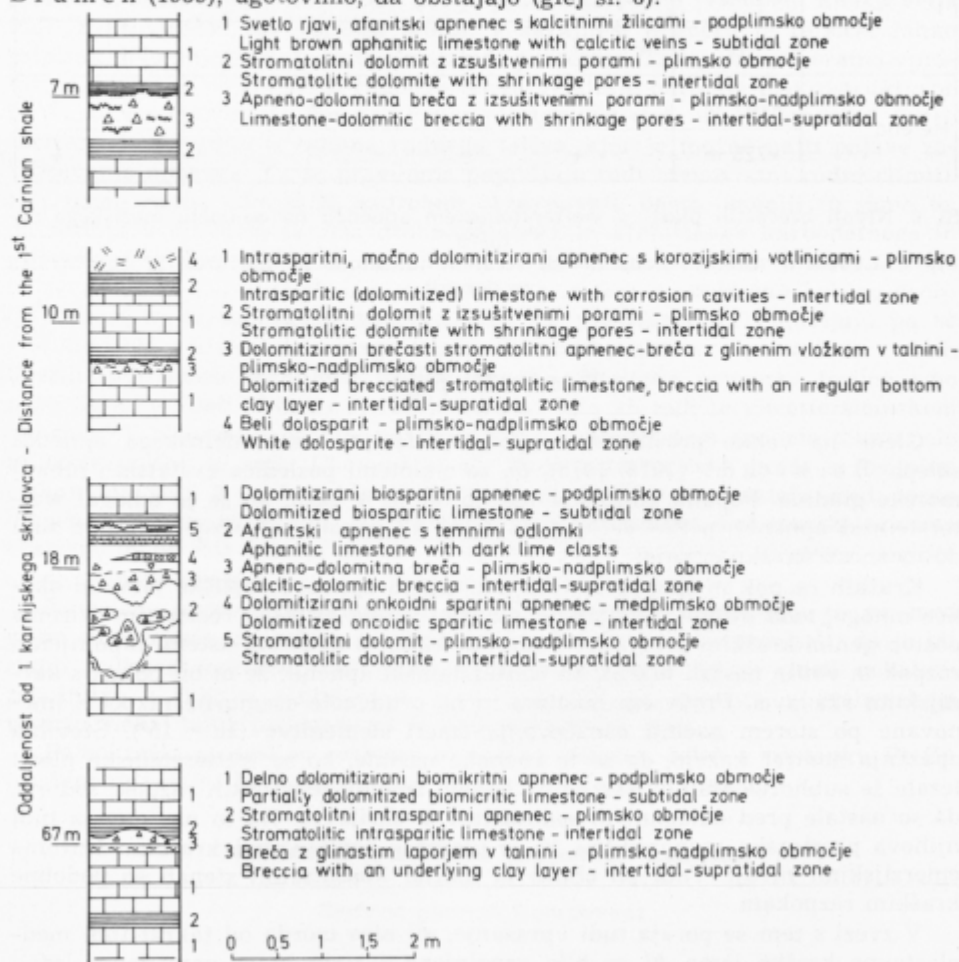
Sl. 5. Detajli cikličnega menjavanja pogojev sedimentacije iz zaporedja wettersteinskih plasti na 7. obzorju v Srednji coni
