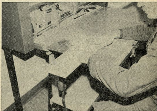
Slika 2. Sestavne dele (pozicije 1, 2, 3, 4) je potrebno zalepiti z neostik lepilom, dno pa ojačati z zalepljeno pluto, ki jo obrežemo z nožem za tapete
