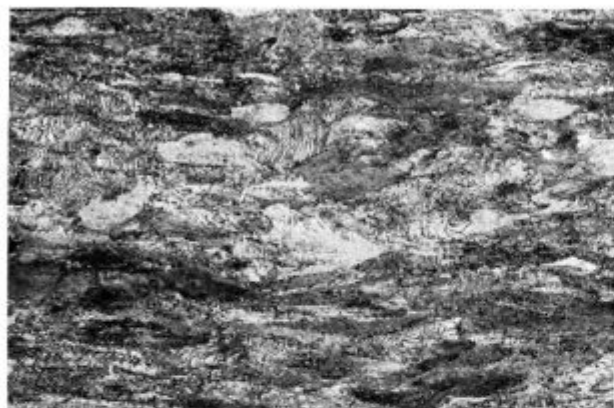
Slika 31 × 500, žica kvalitete Č 4230 vlečene na debelino 3,48 mm (redukcija 66 %). Vozlaste tvorbe cementitnih lamel
