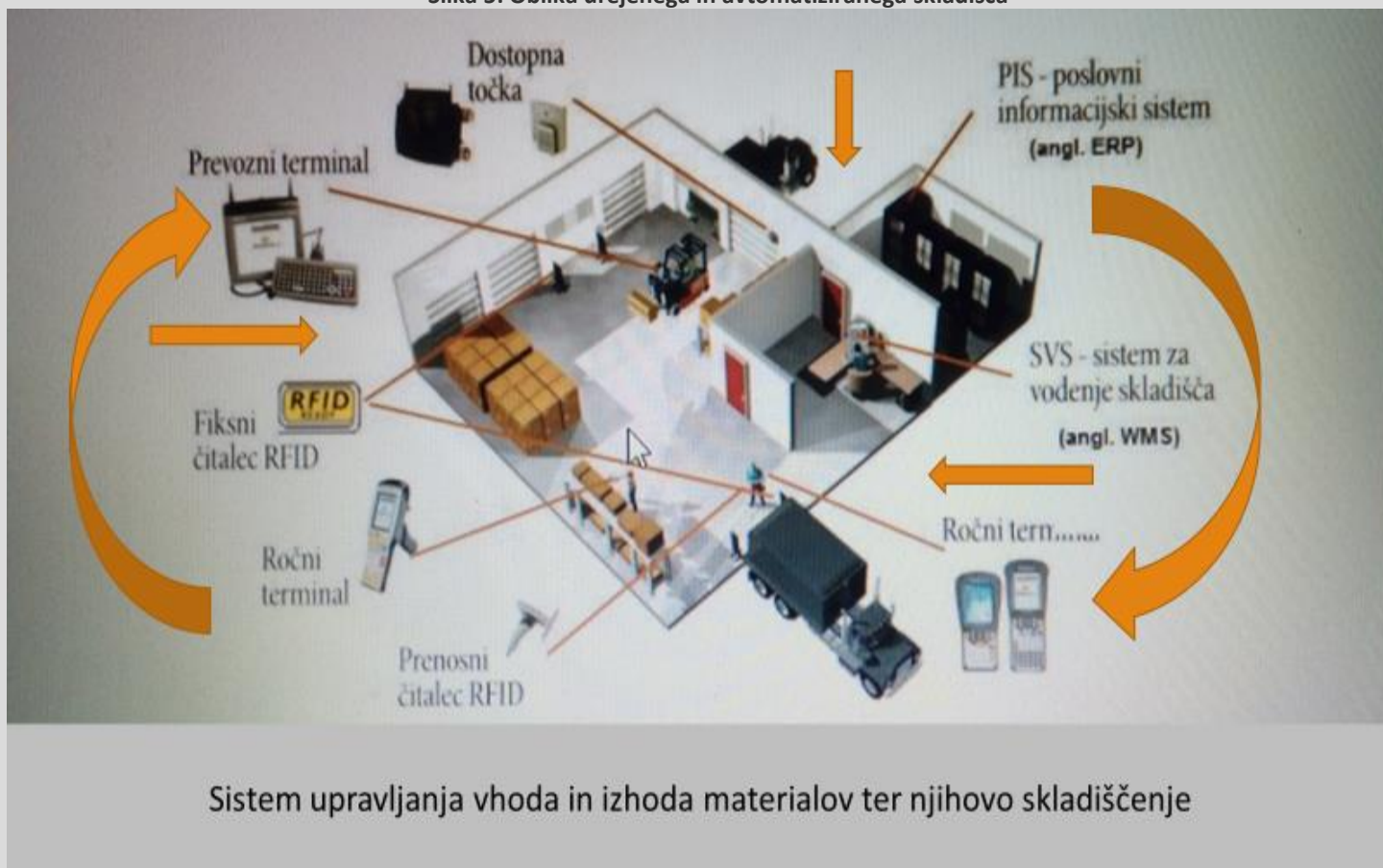
Slika 5: Oblika urejenega in avtomatiziranega skladišča
