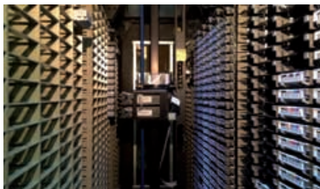
△ Praktično 20 let so ljudje v podjetjih menjavali tračne kasete v računalnikih, saj je šele z modelom 3400 IBM razvil mehanizem samodejnega nalaganja ter navijanja kaset in trakov. Danes imajo podjetja, ki uporabljajo hrambo podatkov na trak, implementirane robotske tračne knjižnice.
