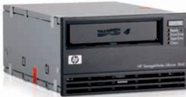
△ Tračni pogoni so se v novejši zgodovini povezovali na računalnike prek vodila SCSI, redki modeli pa so podpirali tudi vmesnike SATA, USB, FireWire in celo Fibre Channel.
