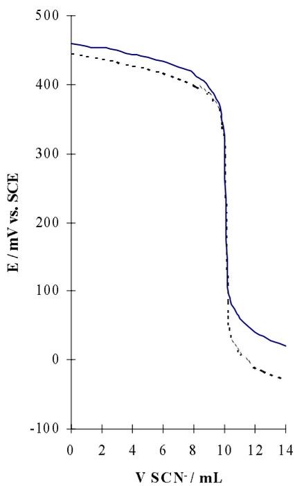
Figure 6.  $\text{Ag}^+$  titration with 0.1 mol/L  $\text{SCN}^-$
