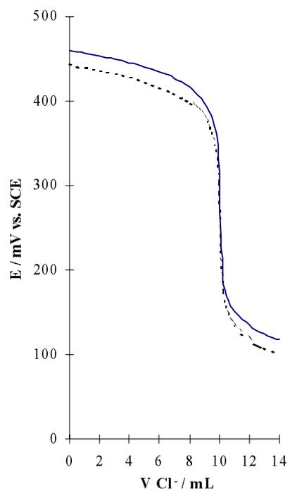
Figure 5.  $\text{Ag}^+$  titration with 0.1 mol/L  $\text{Cl}^-$
