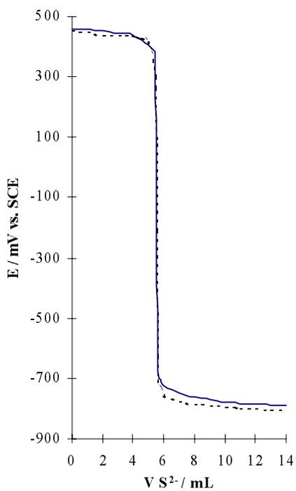
Figure 4.  $\text{Ag}^+$  titration with 0.1 mol/L  $\text{S}^{2-}$
