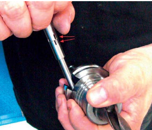
Pri vpenjanju z vpenjalno glavo APC kažeta prekriti oznaki na ključu na pravilni vrtilni moment vpenjanja.
