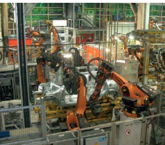
Linija za izdelavo karoserij ima približno 180 robotov.
