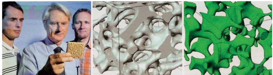
Modeliranje v navideznem svetu: raziskovalci v SCT porozno keramiko (levo) izboljšujejo s pomočjo digitalne kopije mikrostrukture (desno), pridobljene na podlagi digitalnih merjenj z računalniško tomografijo (v sredini).
