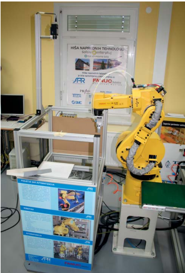
Slika 4: Robotska celica 3 z industrijskim robotom in računalniškim vidom
