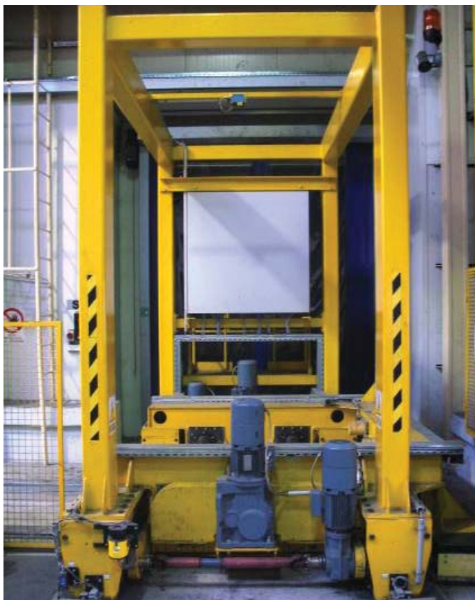
Slika 11: Namestitev prostorskega zaznavala na primarnem vozičku
