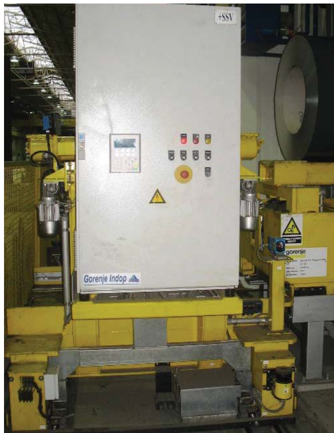
Slika 12: Namestitev prostorskega zaznavala na sekundarnem vozičku
