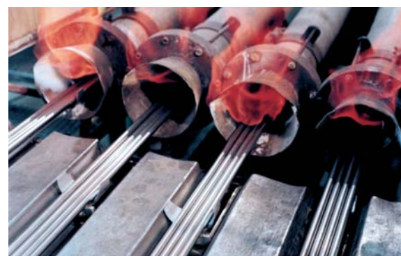
Kaljenje posebne žice v peči za nenehno žarjenje
