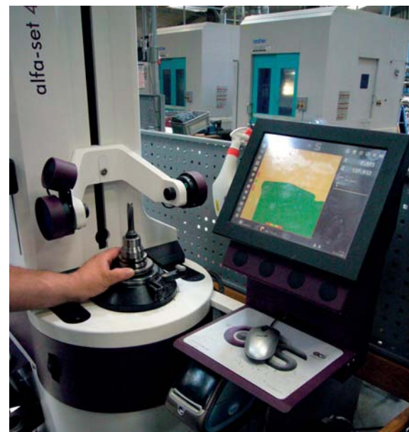
Po prednastavitvi orodij v vpenjalne glave Albrecht imamo zagotovljeno varno in natančno pozicioniranje orodja, zaradi velike vpenjalne sile.
