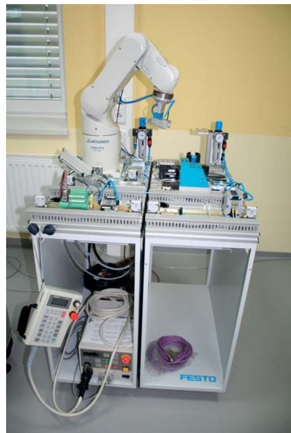
Slika 2: Robotska celica 1 s petosnim učnim robotom
