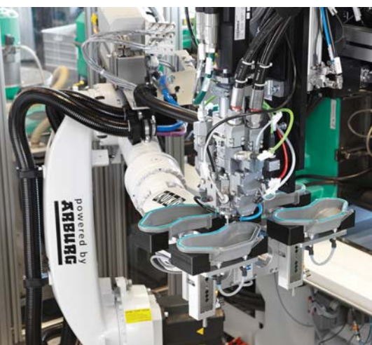
Slika 12a: Stroj Allrounder 570 E in postopek Mold'n Seal
