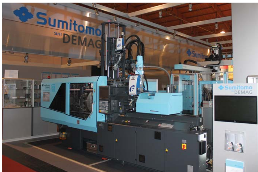
Slika 9: Systec 160 Multi (2 komponentni stroj) za izdelavo optičnih delov
