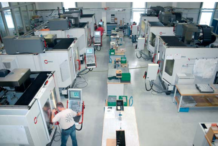
Oddelek za rezkanje pri microartu KG v Rodingu na Bavarskem z obdelovalnimi centri Hermle, levo so štiri enote C 40 U, desno pa tri enote C 30 U
