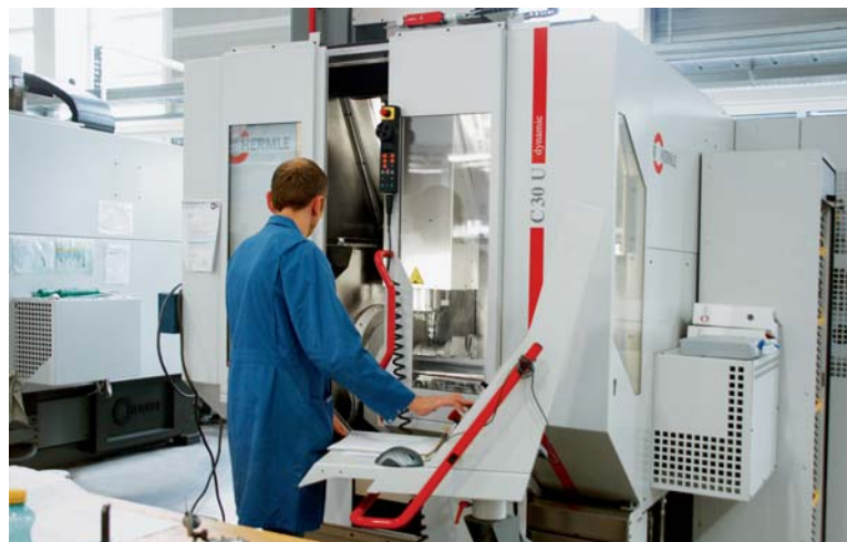
V družbi WIHO se za natančnost in dinamiko zanašajo na trenutno serijo C: petosna obdelovalna stroja C 30 U dynamic in C 40 U dynamic.
