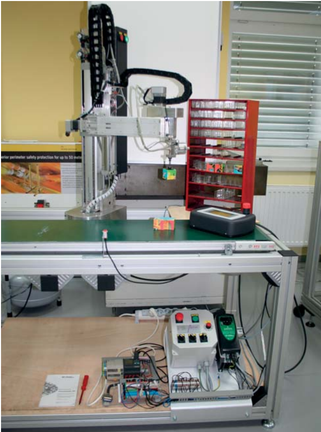
Slika 3: Robotska celica 2 z robotom, tekočim trakom in regalnim skladiščem
