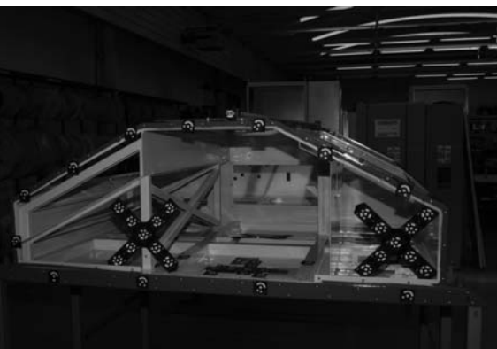
Slika 1: a) Referentno (neobremenjeno) stanje in b) trenutno (obremenjeno) stanje z vektorji premika XYZ
