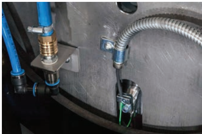
» Kistlerjevi senzori za merjenje obremenitev so neobčutljivi in enostavni za montažo.
