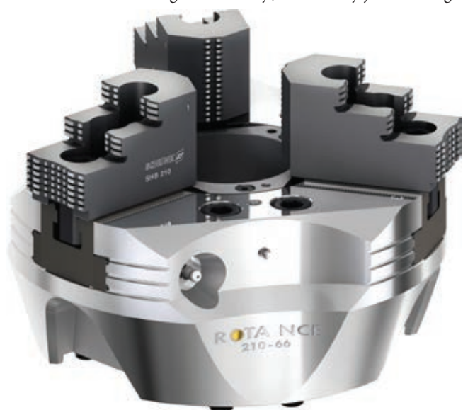
» Optimiran dizajn glede teže zagotavlja vpenjalni glavi SCHUNK ROTA NCE zmanjšanje inercije do 40 %. Zlasti pri velikoserijskih proizvodnji ima stružna vpenjalna glava impresiven učinek s svojo visoko dinamiko, nizkimi stroški in energetsko učinkovitostjo.
