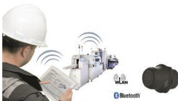
» Slika 3: Delavec preko komunikacije WLAN ali Bluetooth lahko daljinsko upravlja napravo, katere nadzorni sistem je povezan na pristopno točko Wireless BOLT. HMI-panel lahko v takem primeru nadomestimo z oddaljenim pametnim telefonom, PC tablico ali računalnikom.
