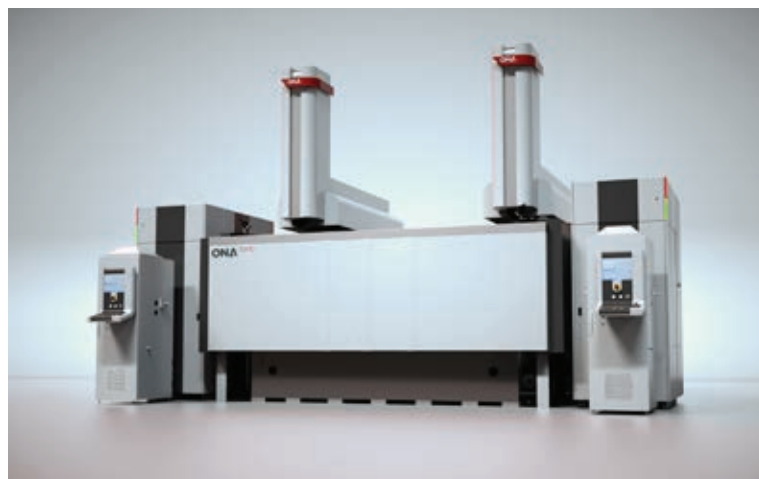
» Potopni stroj EDM ONA TQX10 z dvema glavama in dvema robotoma Erowa ERC80
