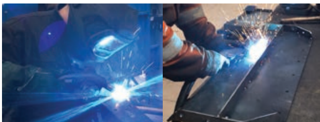
» Vitka zasnova varilne pištole DIX MRZ 304 z odsesavanjem plinov omogoča optimalno dosegljivost mesta varjenja.
