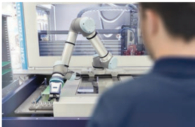
» Timsko delo v elektroniki: robotska roka s prijematom SCHUNK Co-act EGP-C pomaga operaterju pri polnjenju stroja za rezanje tiskanih vezij. Slika: SCHUNK
