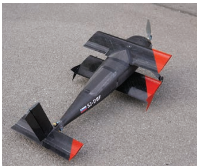
» Končni tekmovalni model z razponom kril 350 mm, dolžino 700 mm in maso 462 g (prazen), ki je letel s hitrostjo več kot 100 km/h
