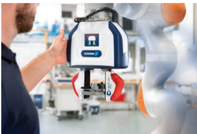
» Prijemalo SCHUNK Co-act JL1 nenehno nadzoruje okolico s kapacitivnimi zaznavali. Če se mu približa človeška roka, samodejno preklopi v varnostni način. Slika: SCHUNK
