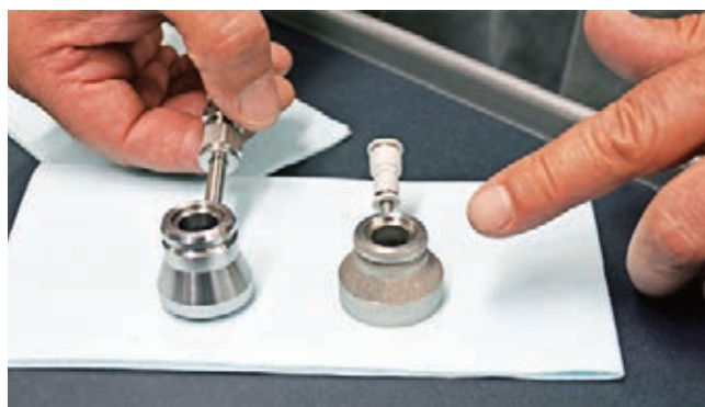
» Re-inženiringom je Concept Laser zmanjšal komponento z dveh delov na eno (Courtesy GE Additive)
