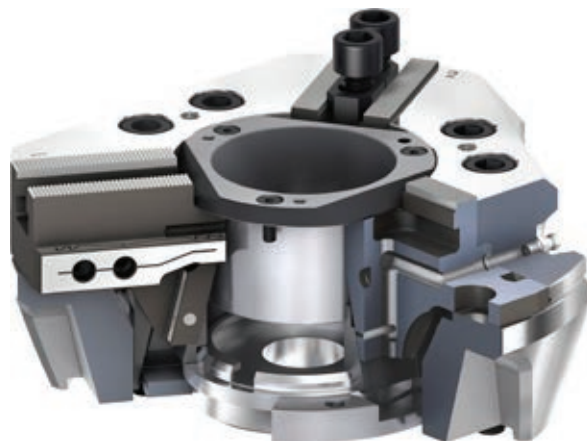
» Lahka stružna vpenjalna glava SCHUNK ROTA NCE (v prečnem prerezu) prepriča z majhno težo in visoko togostjo. SCHUNK je v topologijo in optimizacijo parametrov vložil skupaj 700 FEM ur.
