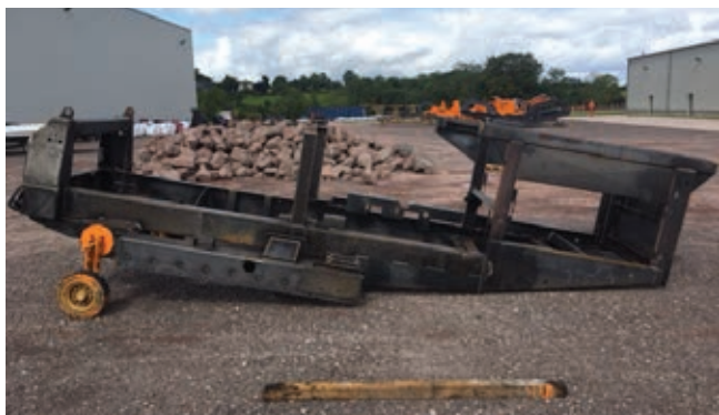
» Vari na osnovnem okvirju morajo zdržati visoke obremenitve.
