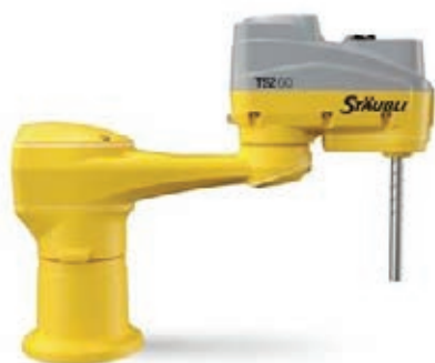
» TS2-60: popolnoma novi SCARA TS2 z modularno zasnovano in prvič opremljen z lastno Stäublijevo JCS tehnologijo pogonov.
