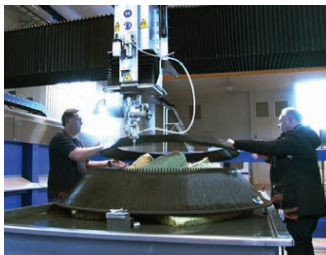
» Preizkus rezanja komponente adapterja za tovor iz karbonskih kompozitov v podjetju Water Jet Sweden. | Vir: Water Jet Sweden
