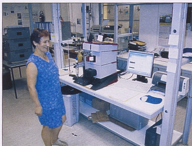
Aparat za merjenje neenakomernosti preje
