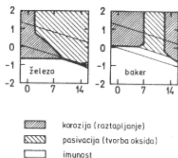
Slika 6. Poenostavljena diagrama potencial-pH za železo in baker
