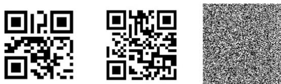
Slika 1: Verzije QR kode: na levi verzija 1 ( 21 \times 21 ), v sredini verzija 2 ( 25 \times 25 ) in desno verzija 40 ( 177 \times 177 )
