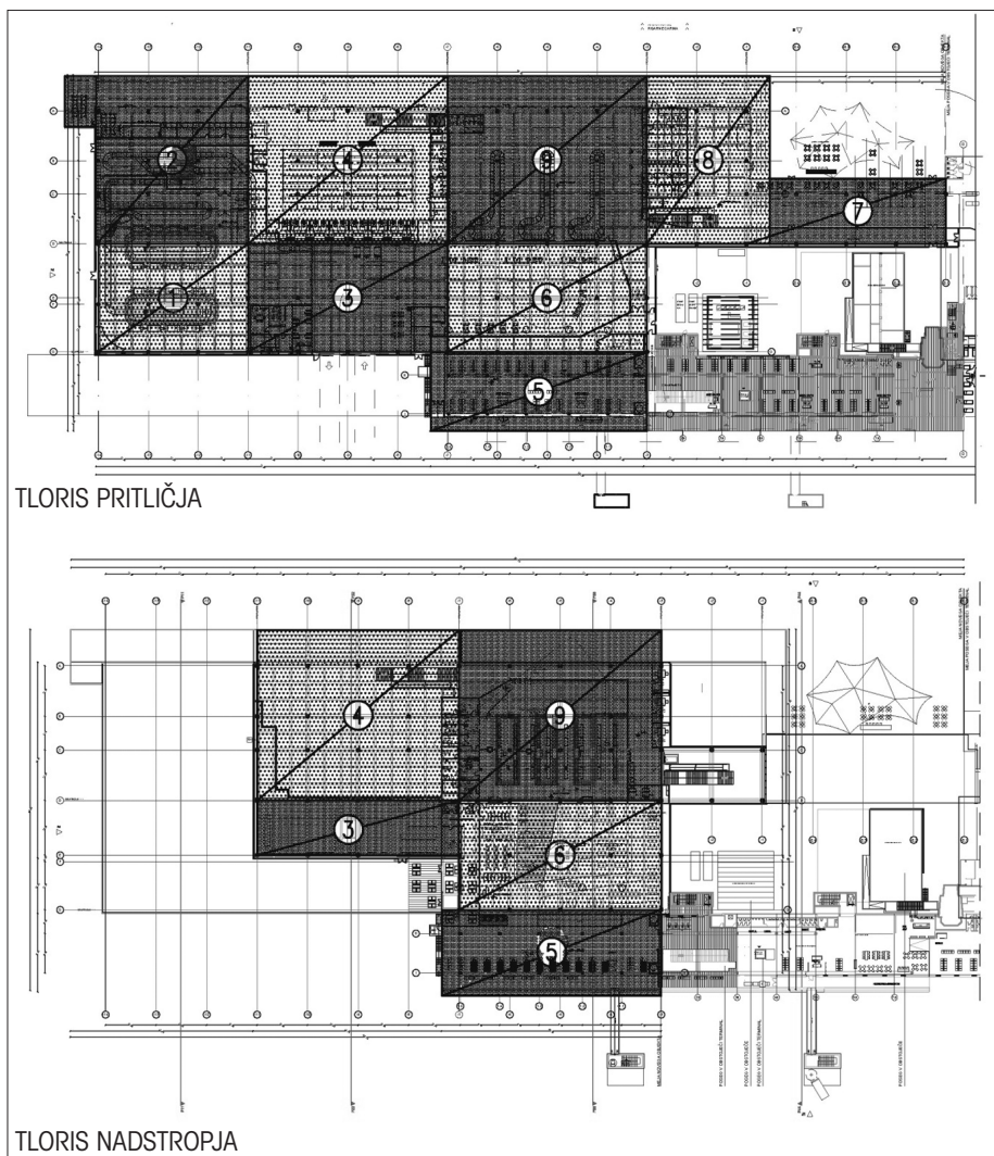
Slika 11 • Shemi dilatacijskih enot.
