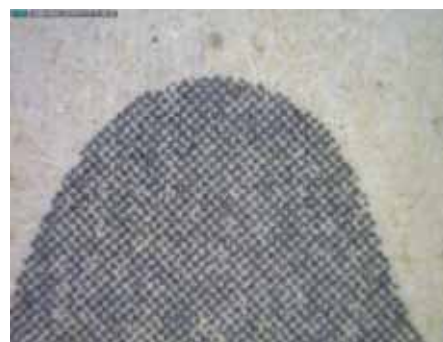
Slika 4: Primerjava tiskovne plošče in izvedenih ofsetnih odtisov dveh različnih gostot, levo 133 lpi, desno 150 lpi (Matej Pivar).
