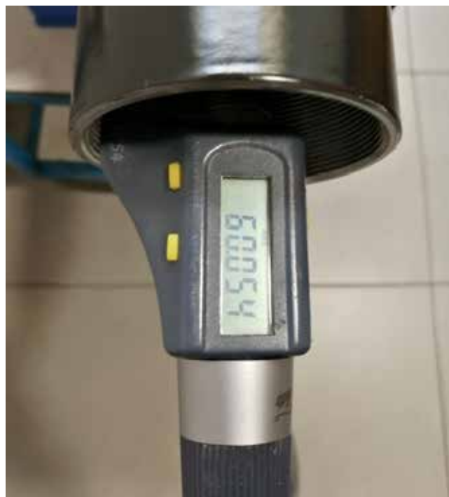
Slika 5 : Meritev notranjega premera cevi hidravličnega valja
