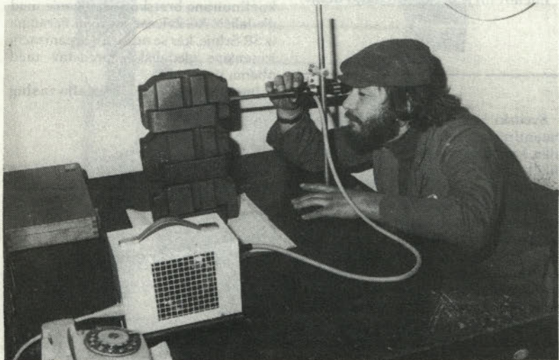
Vizuelna kontrola kanalov krmilnih ohišij NO 20 z intraskopom, ki smo ga dopolnili še s kamero in monitorjem. (foto Arzenšek)
