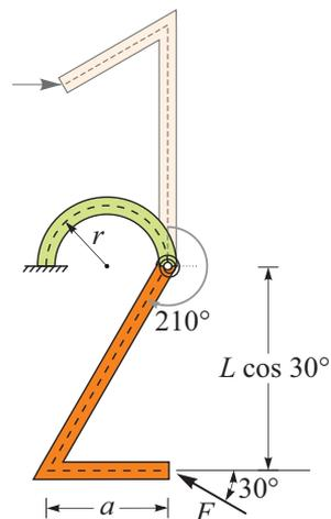
Delo sile  $F$  najlažje izračunamo tako, da določimo spremembo elastične energije v vijačni vzmeti. Ker izgub energije ni, je ta enaka delu, ki jo opravi sila  $F$ .
