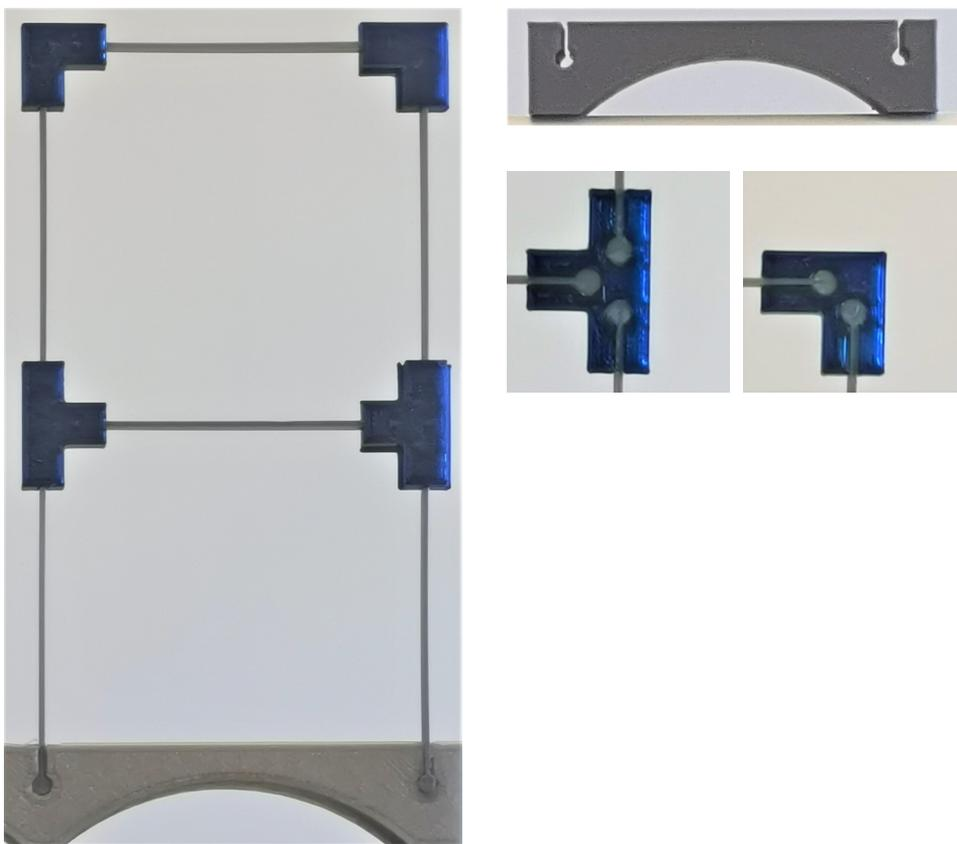
**Rešitev:** Linijski model konstrukcije je prikazan na sliki. V točkah  $A$  in  $B$  sta vpeti podpori, vezi v točkah  $C$ ,  $D$ ,  $E$  in  $F$  so vse toge vezi, ki preprečijo medsebojne pomike in zasuke konstrukcijskih elementov. Če konstrukcijo v mislih razstavimo na štiri elemente  $\overline{AE}$ ,  $\overline{BF}$ ,  $\overline{CD}$  in  $\overline{EF}$ , lahko stopnjo statične nedoločenosti izračunamo po naslednji enačbi:
