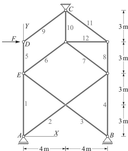
**Rešitev:** Hitro lahko ugotovimo, v katerih paličah so osne sile enake nič: To so paliče 2, 3, 6, 7, 10, 12, 8, 11 in 4. Od nič različne so le osne sile v paličah 1, 5, in 9. Te sile izračunamo iz ravnotežnih pogojev za vozlišči D in E.
