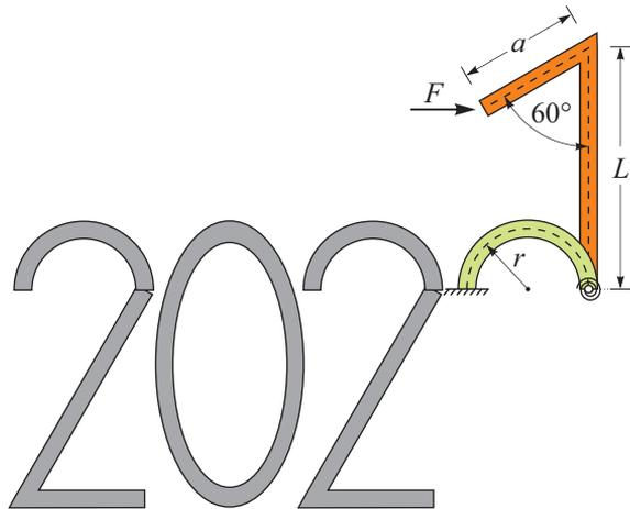
Določite silo  $F$ , ki deluje na enico tako, da bo v deformirani legi iz nje nastala dvojka. Izračunajte delo, ki ga sila  $F$  opravi pri postavitvi prave letnice. (Namig: izračunajte elastično energijo, ki je potrebna za zasuk vijačne vzmeti.)
