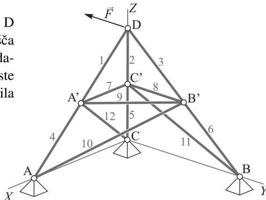
**Pravilo 1:** Če se v NEOBTEŽENEM vozlišču stikajo palice, od katerih vse, razen ene ležijo v eni ravnini, potem je osna sila v palici, ki leži izven te ravnine, enaka nič. Na sliki desno je osna sila v palici 1 enaka nič, ker palice 2, 3 in 4 ležijo v ravnini  $\mathcal{R}$ , palica 1 pa ne leži v tej ravnini.
