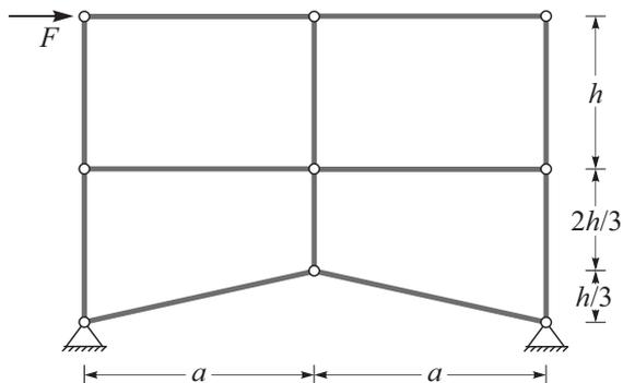
**Rešitev:** Če dodatne palice postavimo tako, da damo eno v prvo etažo, drugo pa v drugo, bo konstrukcija mirovala. Na ta način smo konstrukcijo enakomerno stabilizirali. Če bi obe palice dali v prvo etažo, bi spodnjo etažo pretirano povežali, zgornja pa bi se lahko lahko premikala. Podobno velja, če damo obe palice v zgornjo etažo. Risbe vseh možnih postavitv dodatnih palic, da konstrukcija miruje, so prikazane na naslednji sliki.
