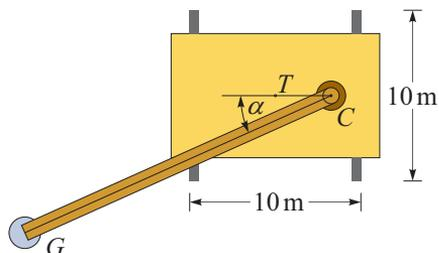
Razdalja med težiščem dvigala  $T$  in osjo teleskopske ročice  $C$  je  $\overline{TC} = 3$  m. Obravnavajte vsaj štiri primere pri različnih kotih  $\alpha$  in skicirajte graf zveze med kotom  $\alpha$  in največjim bremenom.
