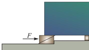
Na vseh stičnih površinah je koeficient trenja enak  $k_t = 0.2$ , zagozdi pa sta odrezani pod kotom  $\alpha = 10^\circ$ .
