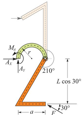
Odstranimo podporo in predpostavimo reakcije  $A_X$ ,  $A_Y$  in  $M_A$ . Iz ravnotežnih pogojev v smereh  $X$  in  $Y$  ter iz momentnega ravnotežnega pogoja glede na točko
