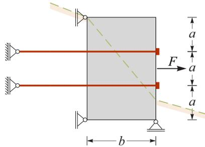
Ko je temelj prednapet, ga obremenimo s silo  $F$ . Kolikšna je lahko največja velikost sile  $F$ , da ni presežena nosilnost geotehničnih sider  $N_c = 2500$  kN.
