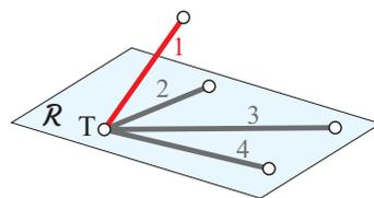
**Pravilo 2:** Če se v NEOBTEŽENEM vozlišču stikajo tri palice, od tega dve kolinearni (ležita na isti premici  $\mathcal{P}$ ), je osna sila v nekolinearni palici enaka nič, osni sili v kolinearnih palicah pa sta enaki. Na sliki desno je osna sila v palici 1 enaka nič, osni sili v palicah 2 in 3 pa sta enaki.
