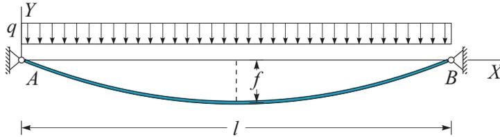
Betonska opornika modeliramo z nepomičnima podporama, brv pa z modelom vrvi, za katerega predpostavimo, da prenaša samo osne sile. Zaradi relativno majhnega povesa  $f/l = 0.02$  lahko upoštevamo, da lastna teža deluje na tlorisno dolžino vrvi, kot prikazuje slika.
