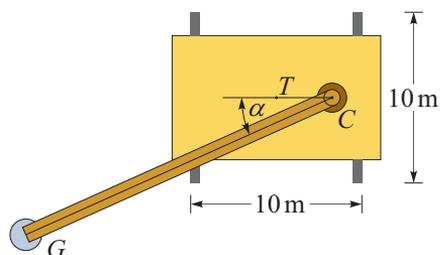
Razdalja med težiščem dvigala  $T$  in osjo teleskopske ročice  $C$  je  $\overline{TC} = 3$  m. Obravnavajte primer, ko je tlorisna lega ročice vzporedna smeri  $TC$  ( $\alpha = 0^\circ$ ), in primer, ko je lega pravokotna na  $TC$  ( $\alpha = 90^\circ$ ).
