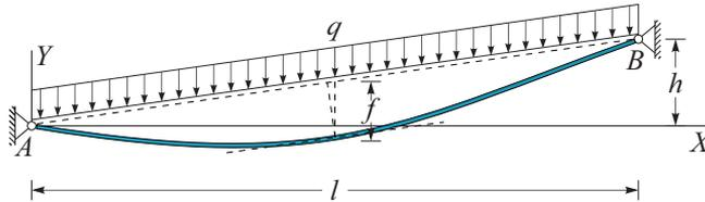
Določite sile (reakcije) brvi na betonska opornika.
