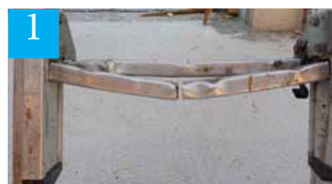
Slika 1: Poškodovan klin lestve
