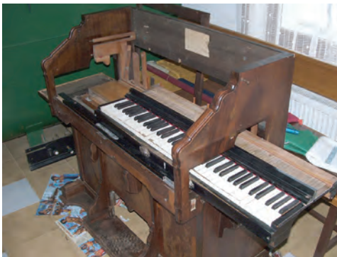
Prikaz premika manuala skozi stranske odprtine na igralniku [2] (foto: J. Pezdirec).
