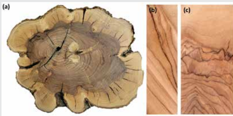
Slika 4: Tekstura oljčnega lesa: prečni (a), radialni (b) in tangencialni (c) prerez (Foto: G. Skoberne, P. Prislan)
