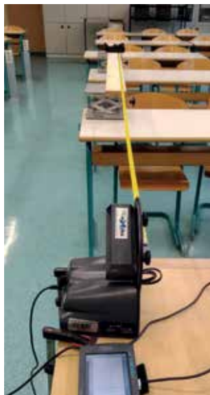
Slika 7: Postavitev pri poševnem metu na isto višino. Deska na dviznih mizicah je na enaki višini kot kroglica v metalcu.
