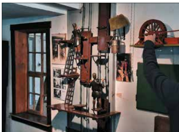
Slika 3. Model pomične lestve, star toliko kot sama naprava. Na njem so se novi rudarji učili uporabe tega nenavadnega dvigala (foto: M. Jančar).
