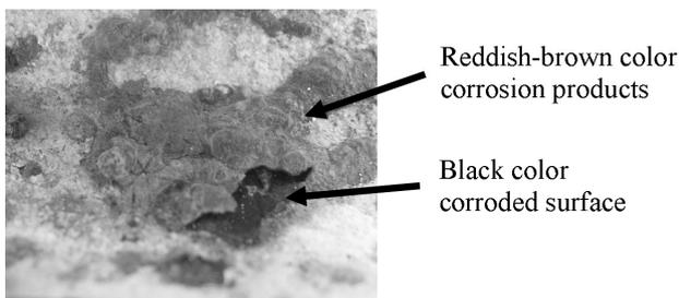
**Slika 4:** Korozijski produkti na površini cevi
