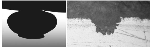
**Slika 5:** Prečni presek korozijske poškodbe levo tipična pri nerjavnih jeklih <sup>10</sup>, desno v našem primeru pri pocinkanju na notranji strani cevi
