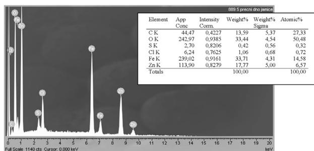
**Slika 6:** EDX analiza produktov mikrobiološke vplivane korozije na površini pocinkanega jekla
