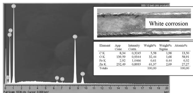
**Slika 7:** EDX analiza produktov in posnetek dela cevi (zgoraj desno) z belo korozijo pocinkanega jekla
