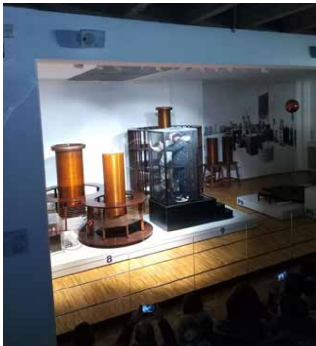
Dijaki v Faradayevi kletki, kjer so varni pred močnim zunanjim električnim poljem, ki ga ustvarja več sto tisoč voltov napetosti Teslinega transformatorja
