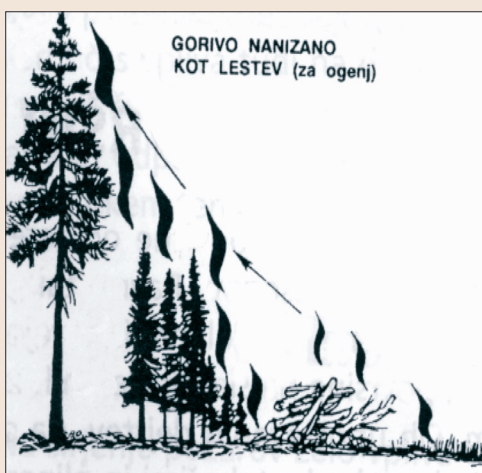
Slika 15: Preskok plamenov po plasteh goriv (Muhič 2004)
