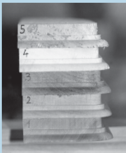
□ Slika 8. Testni vzorci za rezkanje različnih lesov z ocenami obdelovalnostne kvalitete
