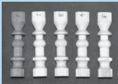
□ Slika 9. Testni vzorci za struženje različnih lesov z ocenami obdelovalnostne kvalitete
