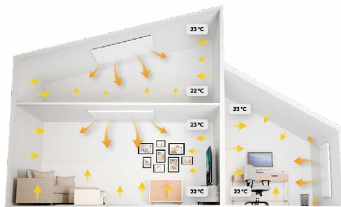
Slika 1: Ustrezno pozicioniranje IR panelov in prikaz delovanja [Ekosen d.o.o.].
