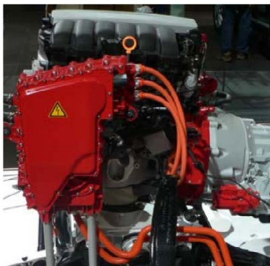
Slika 1: Osnovna zaščita z izolacijo – oranžna barva VN kablov [Vir slike 2].
