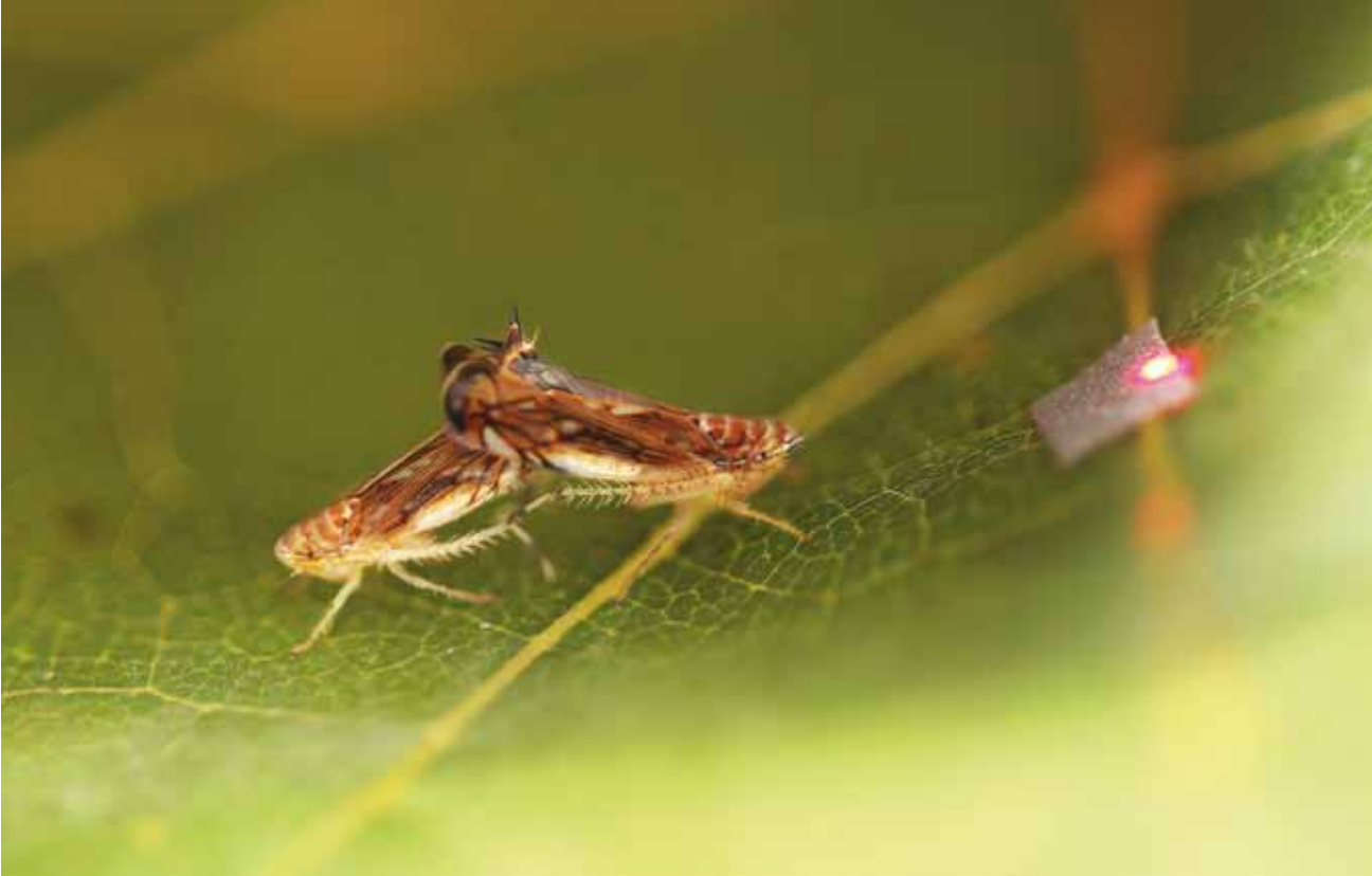
▼ Prek koščka odbojne folije, v katero je bil usmerjen laserski žarek, so raziskovalci ujeli predparitvene vibracijske signale ameriških škržatkov ( Scaphoideus titanus ). (Foto: Jernej Polajnar)
