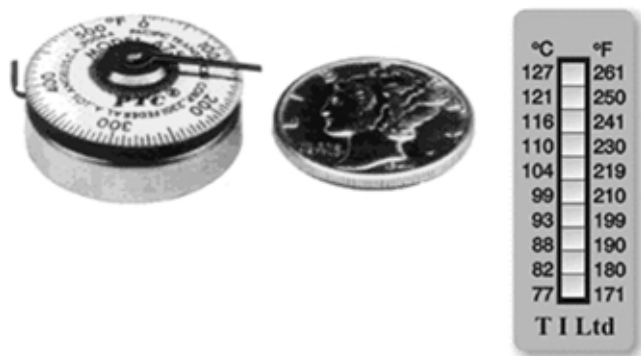
Slika 3: Bimetalni površinski termometer (levo) in temperaturno občutljiva nalepka (desno)
