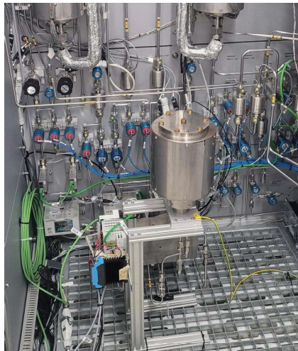
Z internim znanjem razvita komora za H2 teste
