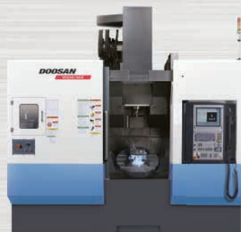
VC630/5AX vertikalni 5-osni center velikost mize: \varnothing 630 mm
