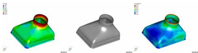
» Slika 3: Komponenta v simulacijskem sistemu Stampack v toku simulacije distribucije debeline (levo). Komponenta po končanju simulacije (sredina). Stopnja izkoriščenosti meje formiranja (desno).
