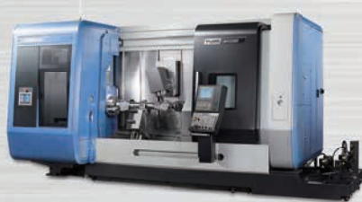
Puma SMX 2600S več-opravljeni stružni center max. kapaciteta: \varnothing 660 \times 1540 mm
