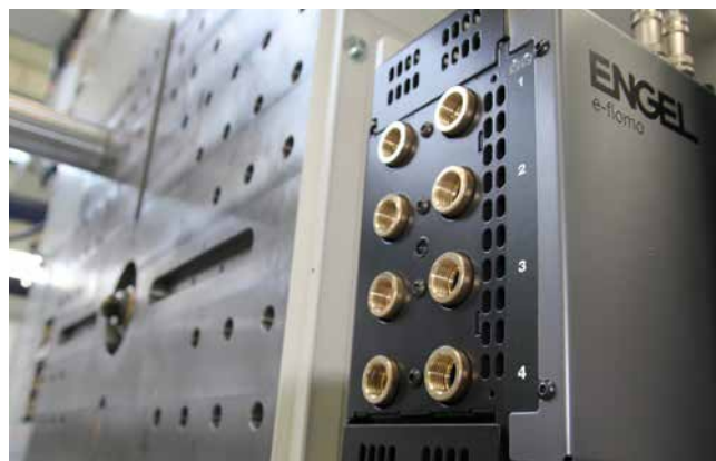
» Slika 2: Razdelilna enota e-flomo tik poleg zapiralne enote stroja (kratke cevi in manjše tlačne izgube)
