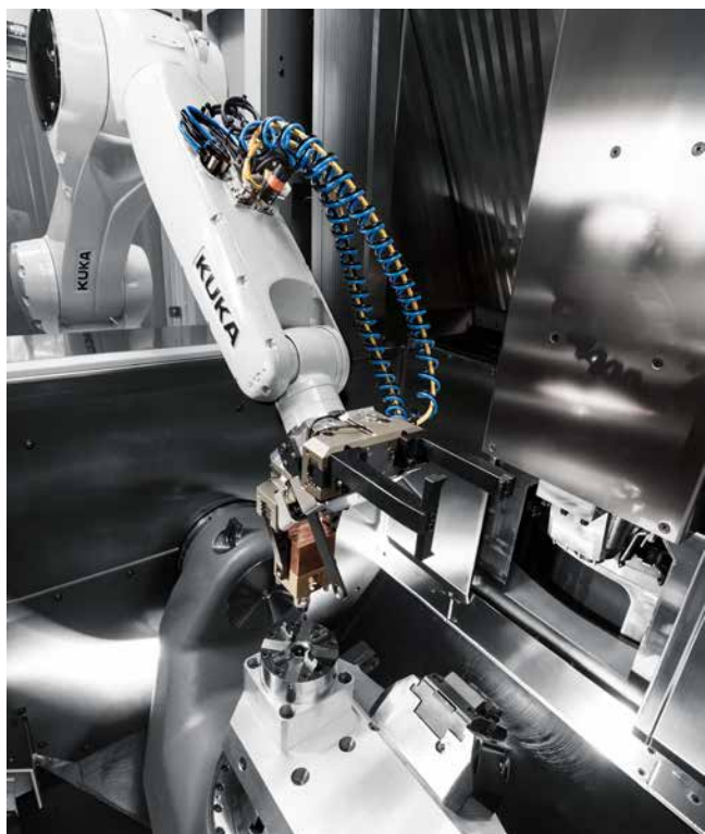
» Kompakten delovni prostor stroja C 12 U med vlaganjem obdelovanca z robotskim sistemom RS 05
