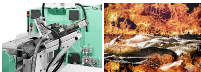
» Slika 2: Dodajalna naprava za dodajanje dolgih vlaken neposredno v brizgalni cilindar, ter vlakna navita v kolutu ob stroju
