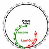
Nepravilno - Ne izberite nadaljevanje krožnega rezanja
