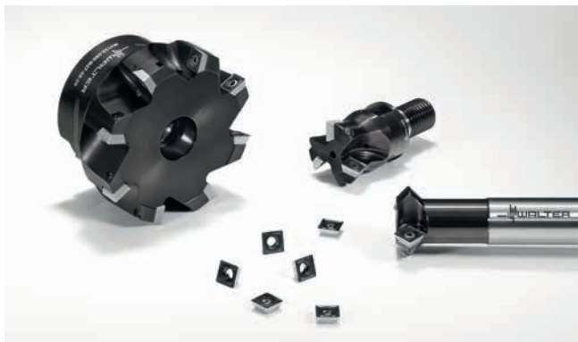
» M4000: vogalni rezkar M4132, »high-feed« rezkar M4002 in fazni rezkar M4574, opremljeni s sistemskimi obdelovalnimi ploščicami SD..09T3..
