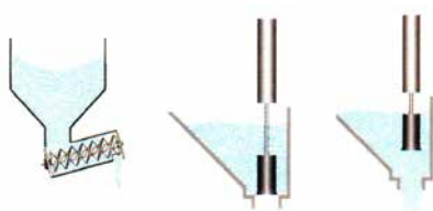
» Slika 1: Shema dozirnega polža (levo) in konusnega ventila (zaprt na srednji sliki in odprt na desni)
