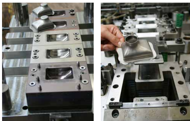
» Slika 4: Zgornji del orodja za postopno globoko vlečenje ter del z neobdelanim srhom. Simuliranje in merjenje smanjajo broj korekcijskih zank potrebnih za izdelavo orodja za globoko vlečenje.
