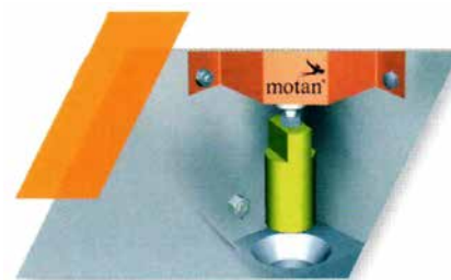
» Slika 3: Doziranje s konusnim ventilom v gravimetričnem šaržnem sistemu
