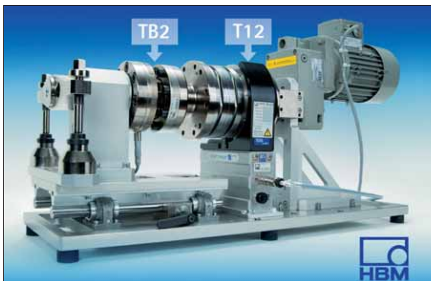
Preskuševališče za kalibriranje merilnih dajalnikov navora (T12), z etalonskim dajalnikom (TB2)
