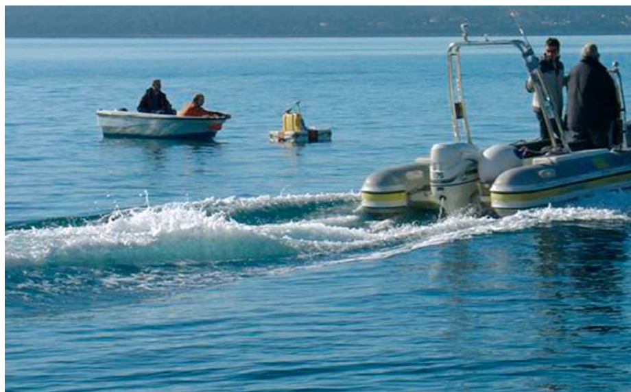
Slika 2 • Povzročanje valov z motornim čolnom in merjenje višine valov
