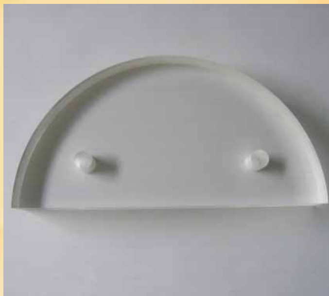
Slika 2: Homogeni fantom iz 2,42 cm debelega pleksi stekla
