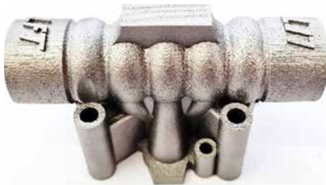
Slika 5 : Optimirana oblika 3D natisnjenega ohišja potnega ventila za vodno hidravliko [20]
