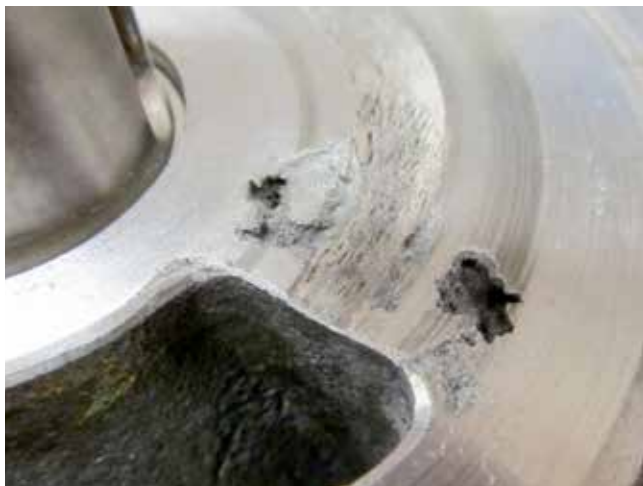
Slika 3 : Kavitacijska obraba ventilske plošče zobniške črpalke z notranjim ozobjem
