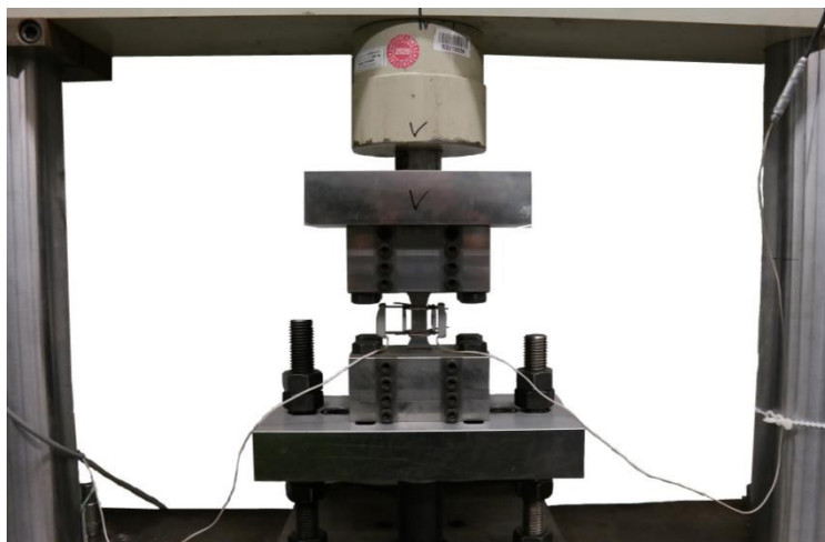
Slika 6. Preizkusi utrujenosti z dvema ekstenzometroma na vzorcih s peno za določitev cikličnega vedenja materiala in virtualnega prožnostnega modula po Youngu E_f
