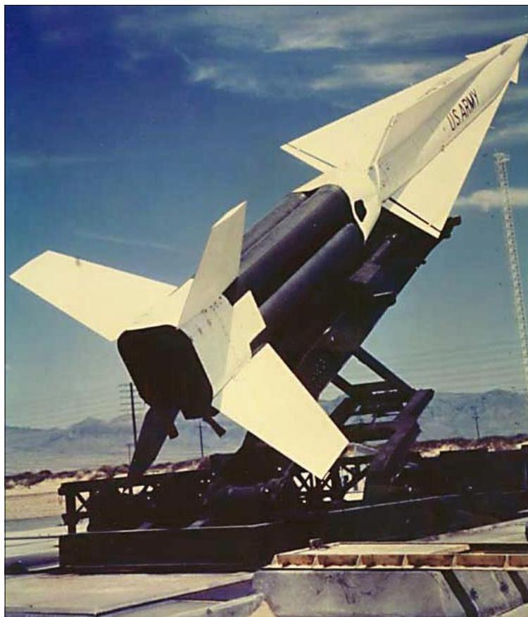
Nike hercules na stacionarni lansirni napravi med dviganjem v položaj za izstrelitev (JZ Kalifornija)
