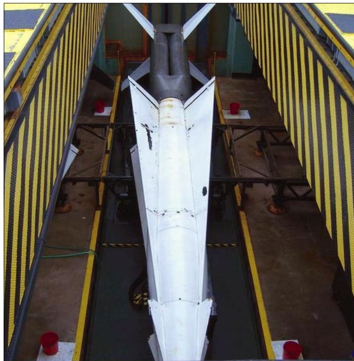
*V podzemnem skladišču baze SF-88-L v Kaliforniji. Rakete na dvizni ploščadi so bile ves čas pripravljene za dvig na površje in takojšnjo izstrelitev.*
