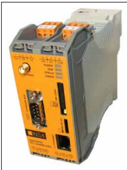
Slika 2. RTU-enota s programsko opremo za komunikacijo s spletnimi portali in socialnimi omrežji [vir: dokumentacija podjetja Inea, d. o. o.]
