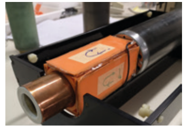
RF sonda za MR slikanje
