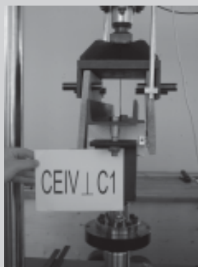
□ Slika 3. Preiskava mehanskega stika med obložno ploščo in lesenim okvirom
