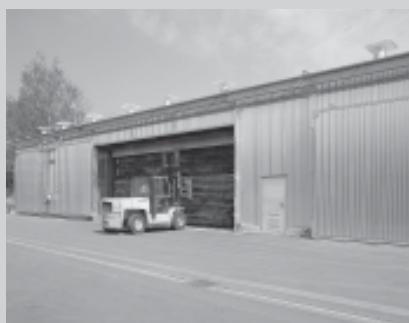
□ Slika 1. Tri sestavljene sušilne naprave podjetja EISENMANN z dvizno pomičnimi vrati za sušenje 80 mm debele, nerobljene bukve najvišje kvalitete. Nakladanje poteka z viličarjem s prednje strani
