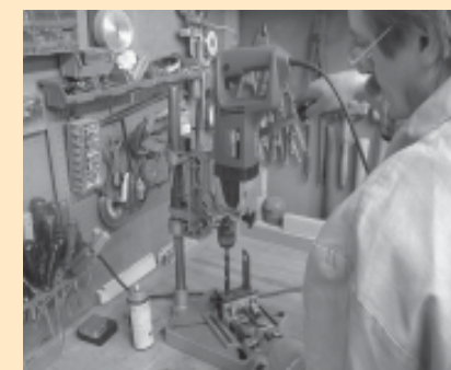
□ Slika 3. Vrtanje kovine z vrtalnikom v stojalu
