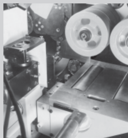
□ Slika 5. Horizontalna rotorja za vertikalno obdelavo lesa s predrezniki
