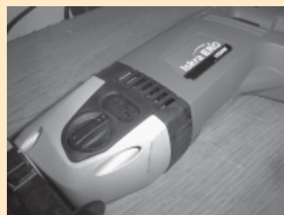
□ Slika 4. Menjalnik obratov in aretacijski gumb
