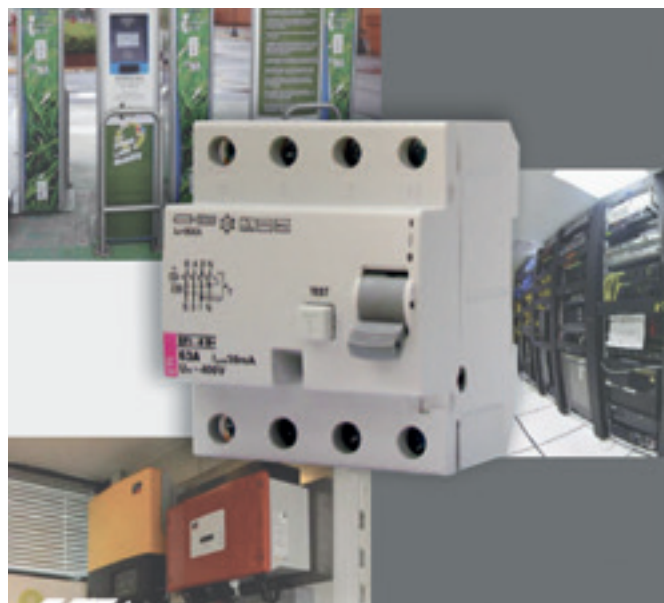
Slika 2: Nova smernica TSG-N-002 sedaj obravnava tudi fotonapetostna napajalna omrežja in polnilnice električnih avtomobilov, v obeh primerih se za dopolnilno zaščito pred posrednim dotikom zahteva RCD stikalo tipa B (varuje tudi pri DC okvarnem toku) – pri polnilnicah zadostuje tip A, če gre samo za AC polnjenje (slika vir: ETI Izlake)
