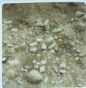
Pretakanje vode v prodno-peščenih usedlinah (Fotografija: Jože Uhan, shema: Darko Simeršek)
