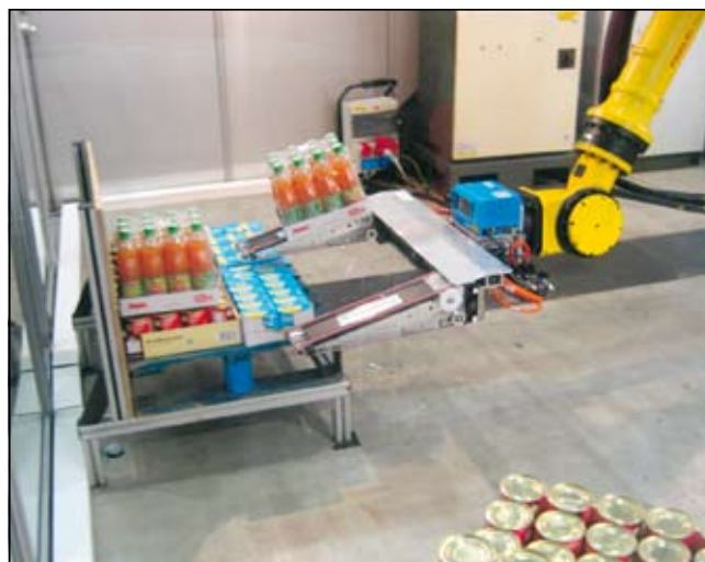
Slika 7. Robot s posebnim prijemalom za samodejno nalaganje kartonov z blagom
