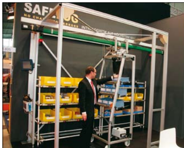
Slika 3. Nabiranje blaga s sistemom za natančno merjenje položaja vozička
