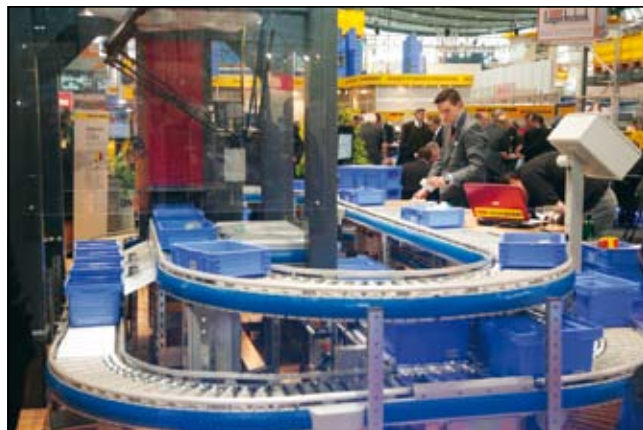
Slika 11. Popolnoma avtomatizirana celica Schäfer Robo Pick za komisioniranje z robotom
