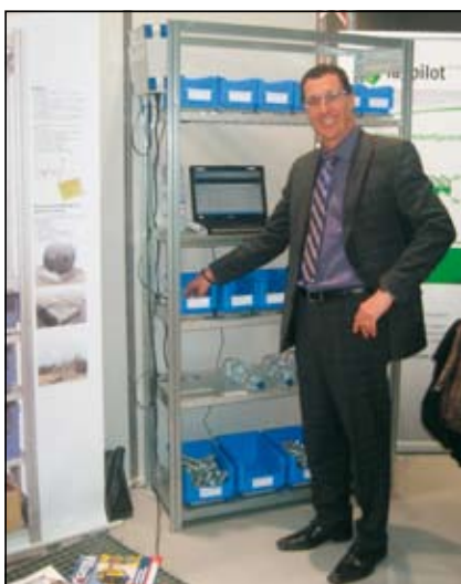
Slika 8. Merilniki pod zabojčkom merijo težo, računalnik pa glede na težo kosa izračuna količino v zabojčku.
