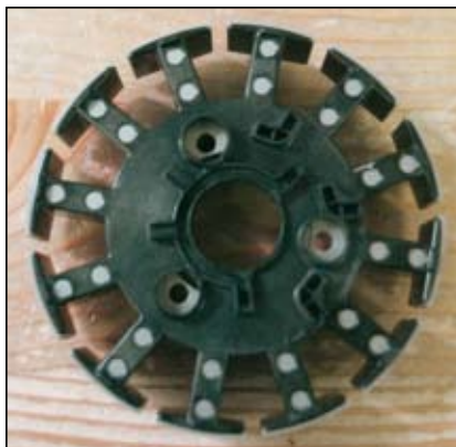
Slika 2. Zabrizgani stator po novi tehnologiji
