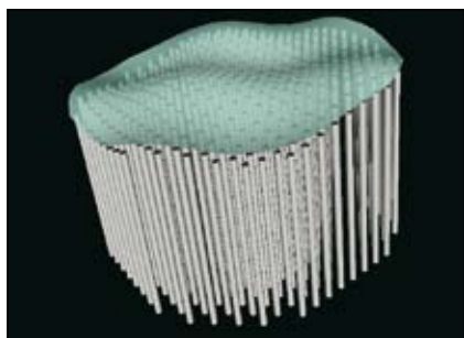
Slika 4. Tanek, fleksibilen zrcalni sistem M4 porazdeljen preko mreže 8.000 aktuatorjev se lahko deformira vsakih nekaj milisekund in na ta način kompenzira motnje v atmosferi.
