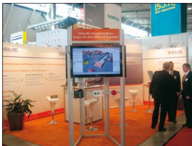
Slika 9. Virtualni zagon oziroma preizkus krmilne opreme s simulacijo na digitalnem modelu načrtovanega logističnega sistema. Pod zaslonom je Siemensov krmilnik, ki krmili model logističnega sistema, prikazanega na zaslonu.
