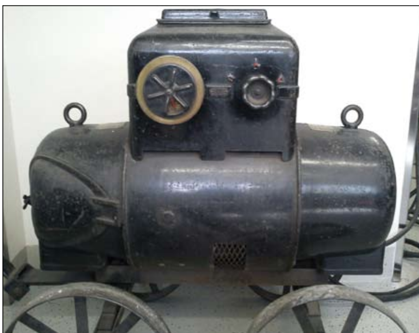
Varilni agregat za ročno obločno varjenje Kjellberg
