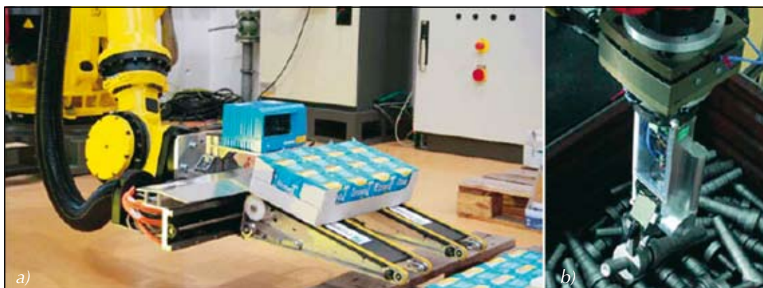
Prijemalo s trakom (a) in prijemalo za prijetanje v zabojih (b)
