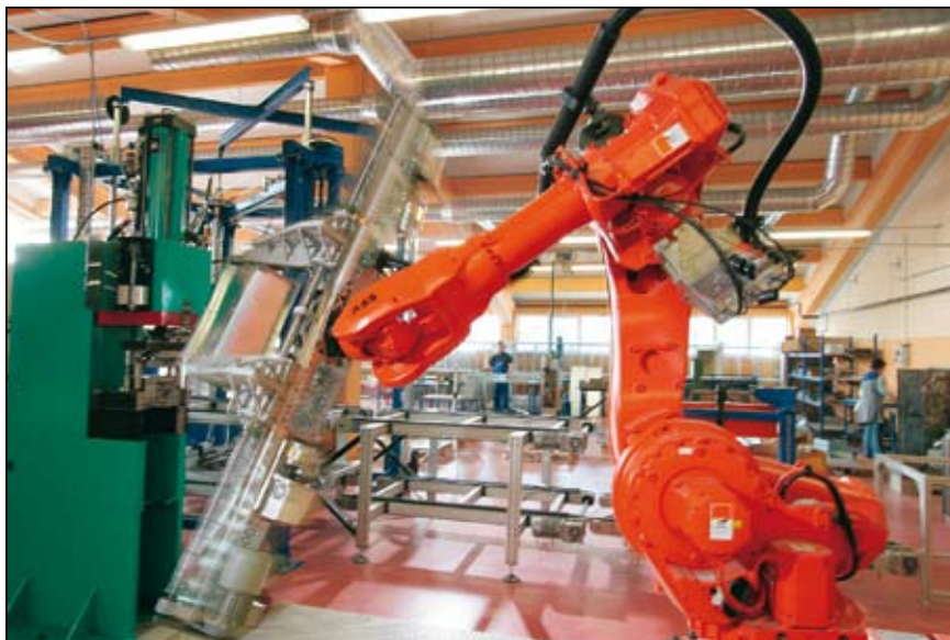
Hladno spajanje kovinskih izdelkov z industrijskim robotom ABB IRB6600
