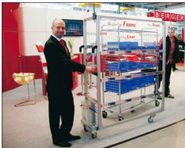
Slika 2. Sistem Pick-by-frame™ z zamenljivim okvirom na vozičku za nabiranje
