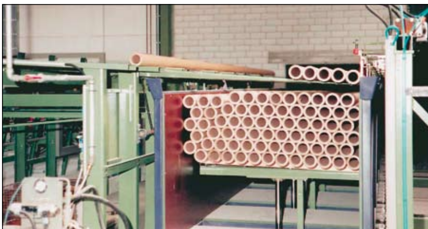
Slika 3. Kopičenje cevi (pogled B na sliki 1)
